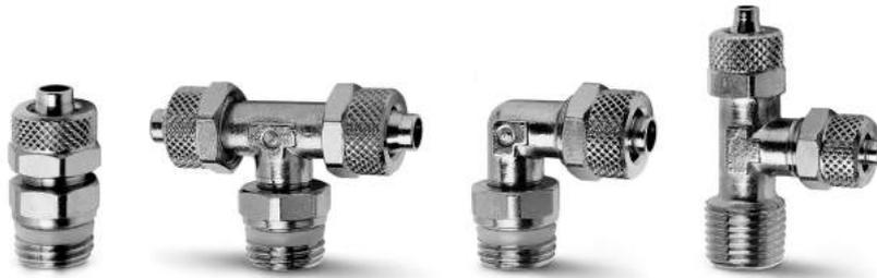
Los racores rápidos Serie 1000 de cánula se pueden montar fácilmente. Las tuercas de bloqueo de la cánula se pueden apretar manualmente o con una llave, incluso con tubos rígidos de PA y Poliéster Hytrel. La especial forma del cono de conducción impide posibles cortes del tubo.
