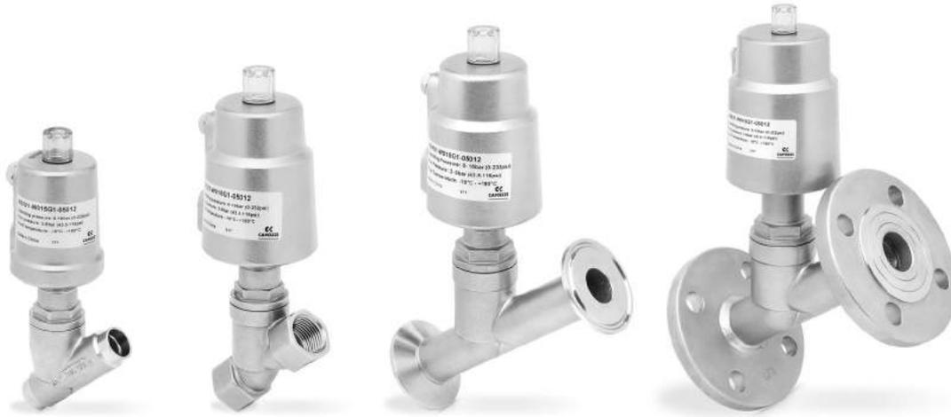
Las válvulas de asiento inclinado están disponibles en distintas versiones con respecto al diámetro nominal, tipo de fluido y conexiones al proceso. Son capaces de manejar fluidos corrosivos o que contengan partículas sólidas suspendidas, pudiendo usarse en aplicaciones con altas temperaturas de funcionamiento.
