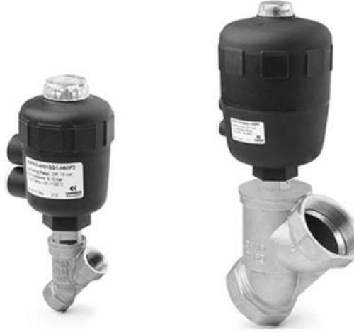
Las válvulas de asiento inclinado de la serie ASP son una solución eficiente y económica para el control de fluidos. Su robustez es adecuada para las más variadas aplicaciones con gases y líquidos, con vapor o con fluidos con partículas sólidas en suspensión. Disponible con conexiones roscadas de 3/8" a 2-1/2".
