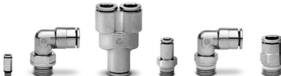
Los racores super-rápidos Serie 6000 han sido diseñados con una pinza especial que proporciona un agarre homogéneo en toda la superficie de los tubos de plástico, asegurando alta fiabilidad y una larga vida útil, aún después de muchas conexiones y desconexiones del tubo. La amplia gama de estos racores incluye varios tipos de roscas: métricas, BSP y BSPT.
