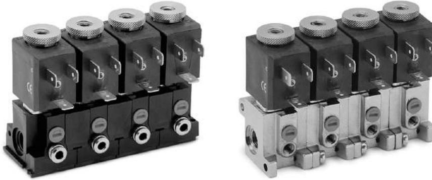
Las electroválvulas de la Serie A son del tipo con mando directo y pueden funcionar con aire seco o lubricado. Están disponibles en la versión 2/2 y 3/2 vías, tanto con función normalmente cerrada (NC) como con función normalmente abierta (NO).
