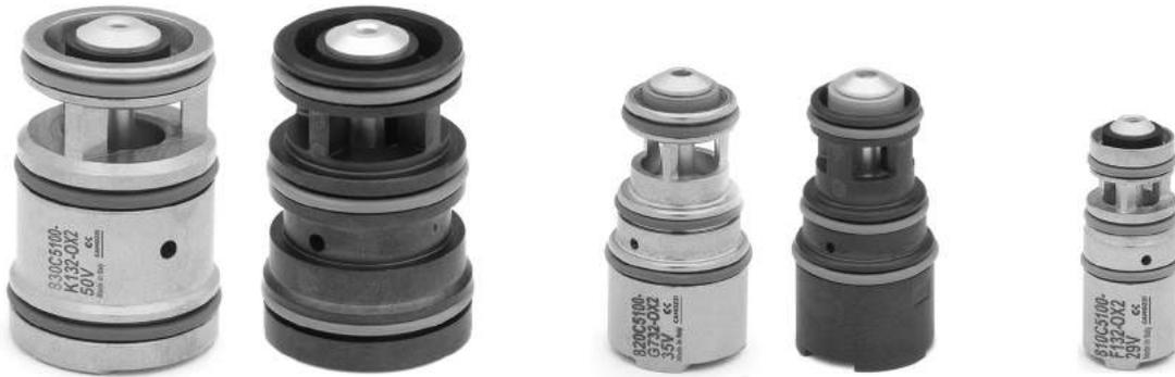
Las válvulas operadas neumáticamente de la Serie 8 son adecuadas particularmente para aplicaciones que requieren un alto caudal, con un diseño compacto. La válvula es operada neumáticamente por pilotos, los cuales son dimensionados de acuerdo con el tamaño de la válvula. El diseño es del tipo cartucho, el cuál es ideal para el montaje en colector, lo que permite la reducción de tamaño y de conexiones neumáticas.
