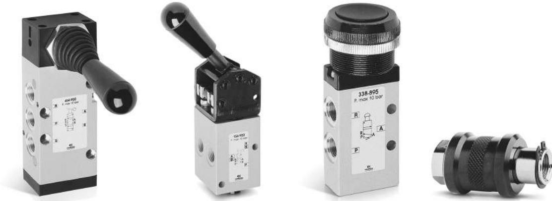
Las válvulas manuales Serie 3 (G1/8) y Serie 4 (G1/4), 3/2, 5/2 y 5/3 vías están disponibles con varios dispositivos diseñados para satisfacer diferentes necesidades. La Serie 1 ofrece dos dispositivos: botón operador (3/2 vías) y palanca (3/2 y 5/2 vías). Las válvulas Serie VMS son tipo corredera 3/2 vías, las cuales están disponibles con puertos M5, G1/8, G1/4, G3/8, G1/2 y G3/4.
