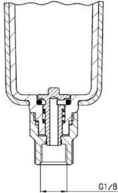
Para evitar la descarga del condensado, el mecanismo operador debe ser girado en sentido de las agujas del reloj, cerrando completamente la descarga.
