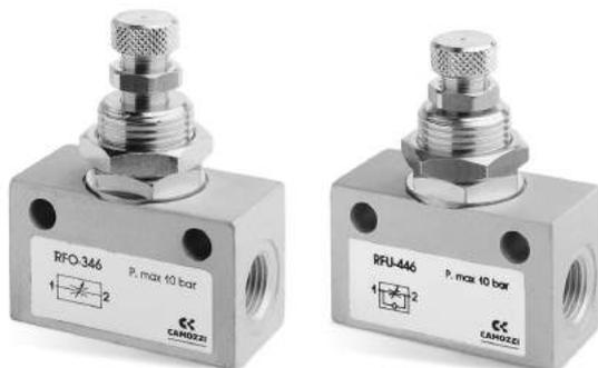
Los reguladores de caudal unidireccionales están equipados con conexiones M5, G1/8, G1/4, G3/8 y G1/2. Las conexiones G1/8 y G1/4 están disponibles con dos tipos diferentes de ajuste, mientras que las conexiones M5, G3/8 y G1/2 tienen un solo tipo de ajuste. Todos los modelos pueden ser montados en panel o en pared o se pueden montar en cilindros, según sea necesario.
