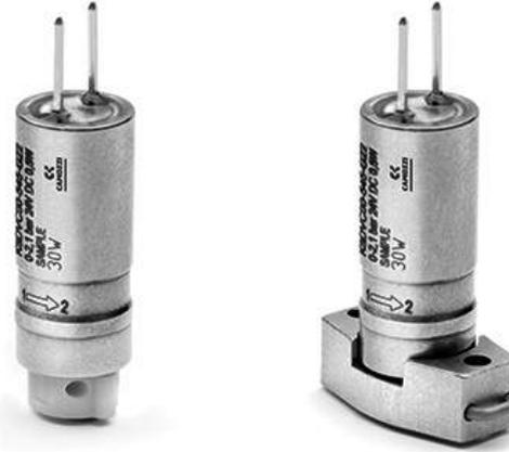
La electroválvula K8DV está diseñada para satisfacer todas las necesidades de interceptación de fluidos agresivos o sensibles al calor. Gracias a la membrana de separación, el fluido está protegido del contacto con las partes metálicas internas y del calor generado por el solenoide.
